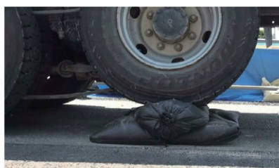
縮災土のう(45軸の繰り返し)
