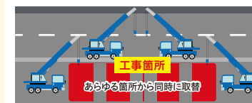
交通規制時間短縮のため、仮設防護柵を迅速に設置・撤去できるロードジッターシステムを採用
