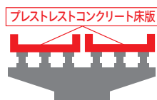
プレストレストコンクリート床版への更新
