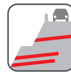
盛土補強 (水抜きボーリング)
