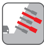
のり面 (グラウンドアンカー)
