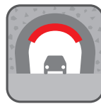
トンネル (覆工補強)
