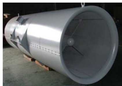
《トンネルジェットファン（補修後）》
