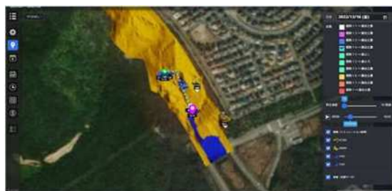
3次元データを利用した切土施工管理
