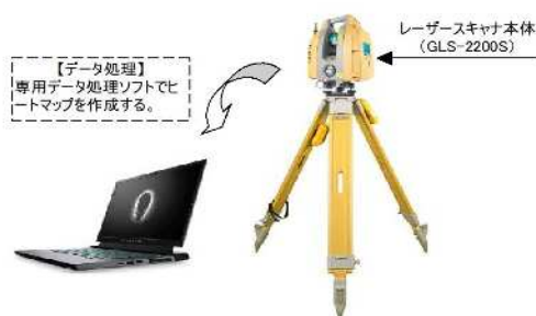
図-1 3D レーザスキャナ測定機
