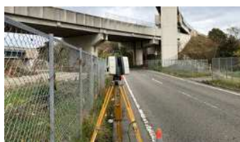
地上レーザー測量
